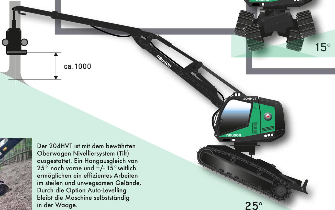
Der 204HVT ist mit dem bewährten Oberwagen Nivelliersystem (Tilt) ausgestattet. Ein Hangausgleich von 25° nach vorne und +/- 15° seitlich ermöglichen ein effizientes Arbeiten im steilen und unwegsamen Gelände. Durch die Option Auto-Levelling bleibt die Maschine selbstständig in der Waage.
