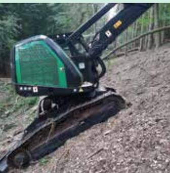
La 204HVT est équipée du système de nivellement de la partie supérieure éprouvé (inclinaison).
