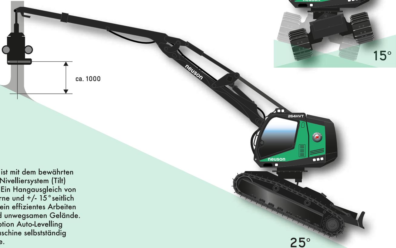
Der 264HVT ist mit dem bewährten Oberwagen Nivelliersystem (Tilt) ausgestattet. Ein Hangausgleich von 25° nach vorne und +/- 15° seitlich ermöglichen ein effizientes Arbeiten im steilen und unwegsamen Gelände. Durch die Option Auto-Levelling bleibt die Maschine selbstständig in der Waage.
